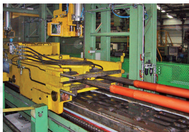
Double internal gripper system for copper tubes 铜管使用的内部夹持双系统
